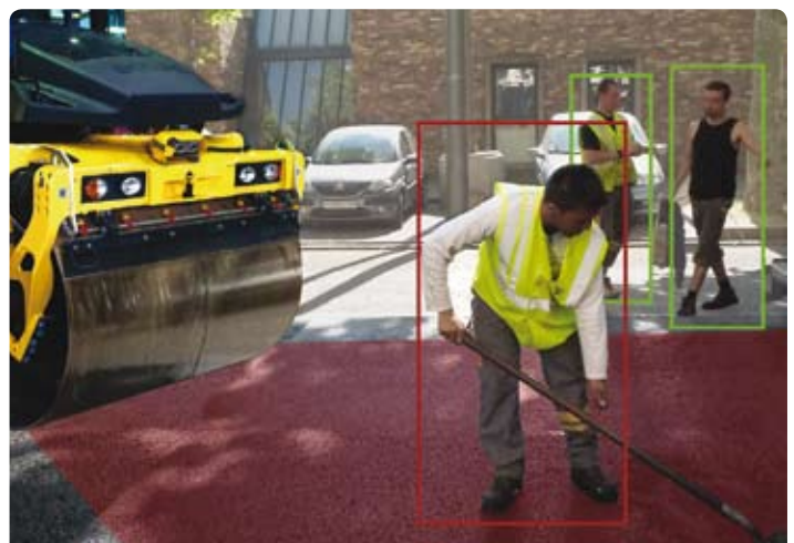
Fußgänger-Erfassungszone einer Straßenwalze: Blaxtair® erkennt alle Menschen in seinem Umfeld und warnt den Fahrer vor Fußgängern in der definierten Gefahrenzone (rot=innerhalb Gefahrenzone / grün=außerhalb Gefahrenzone).
