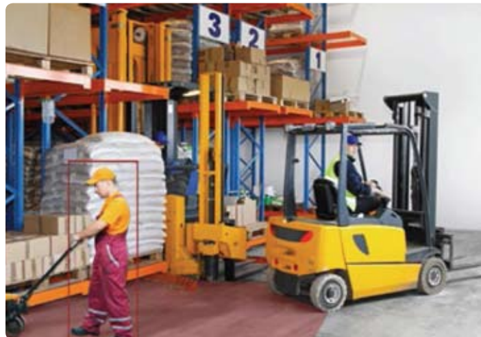
Fußgänger-Erfassungszone eines Gabelstaplers: Blaxtair® erkennt alle Menschen in seinem Umfeld und warnt den Fahrer vor Fußgängern in der definierten Gefahrenzone.
