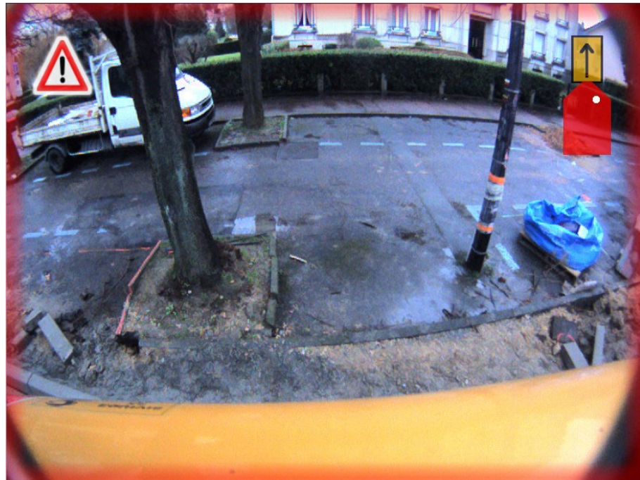
Beispiel für Hinderniserkennung: roter Rahmen und Warnsymbol. Oben rechts zeigt eine Radaranzeige den Erkennungsbereich (rot) und die ungefähre Position der erkannten Hindernisse (weißer Punkt) an.
