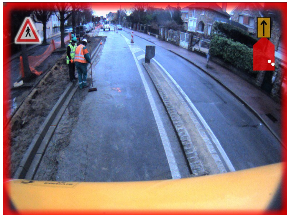
Beispiel für Fußgängererkennung: roter Rahmen und Fußgängersymbol. Oben rechts zeigt eine Radaranzeige den Erkennungsbereich (rot) und die ungefähre Position der erkannten Fußgänger (weiße Punkte) an.
