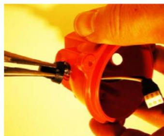
Abb. 13: Mit Zange Drehknopf von Schalter abziehen.
