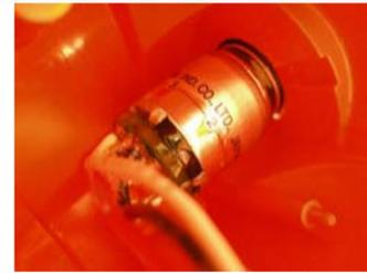
Abb. 15: Drehschaltereinheit wird an der Innenseite des Gehäuses angebracht.
