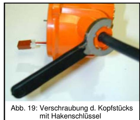
Abb. 19: Verschraubung d. Kopfstücks mit Hakenschlüssel
