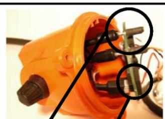
Abb. 12: Stiftkontakte und Blockstecker von PCB-Platine lösen.
