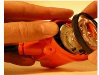
Abb. 10: Entnehmen bzw. Plazieren der TIR-Linseneinheit.
